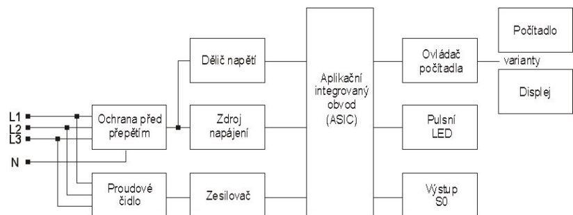
Obr. 16 – Blokové schéma vnitřního zapojení KWZ
