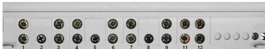
Obr. 5 Pohled na svorkovnici verze pro nepřímé měření
