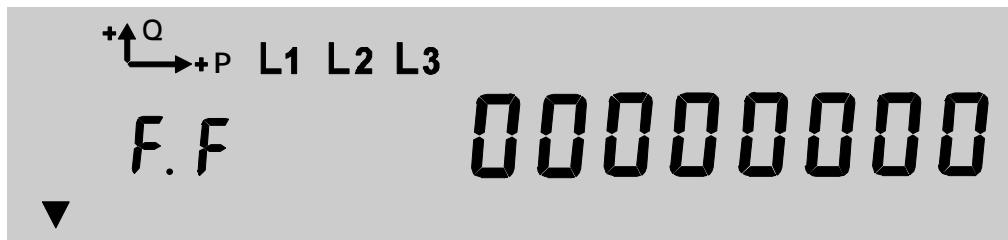
Při zjištění závady, kterou melze odstranit, je třeba elektroměr vymontovat a odeslat do nejbližšího servisního střediska. Fatální chyby se zobrazují na displeji blikáním F.F. V tomto případě je třeba elektroměr neprodleně nahradit.
