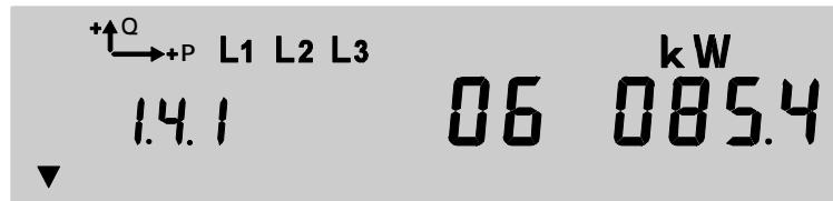
Indikátory fází L1, L2 a L3 se zobrazují, jestliže jsou k dispozici fázová napětí (> 20V) a je v pořadku směr točivého pole. Pokud jedna fáze není k dispozici, chybí odpovídající symbol. Při obráceném sledu fází symboly blikají.
